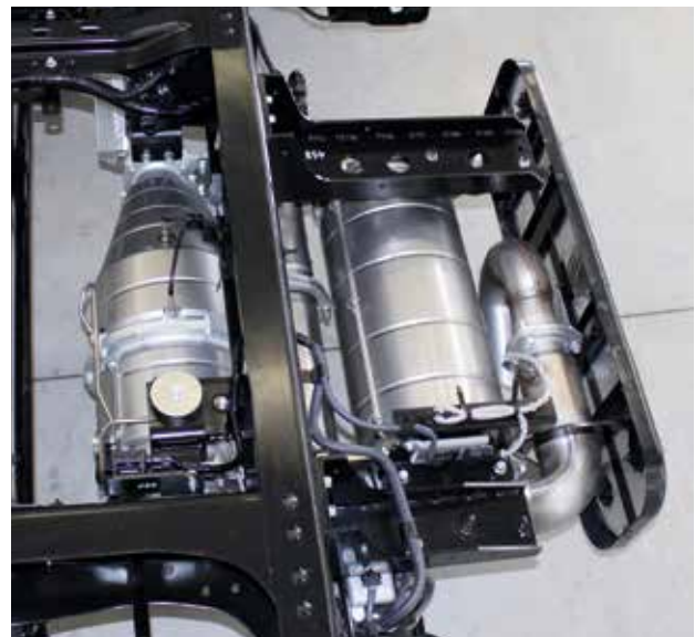
System DPD vlevo, SCR vpravo
